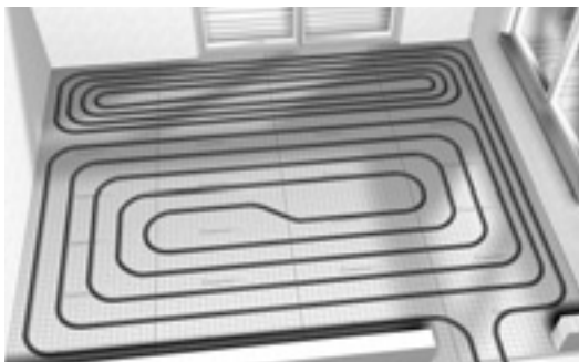
Obr. 3: Spirálovitý způsob pokládky s integrovanou okrajovou zónou
