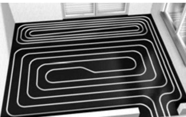
Obr. 3: Spirálovitá pokládka s oddělenou okrajovou zónou
